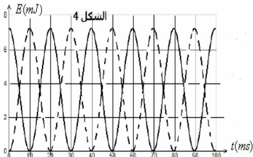
4. تحقق هذا الشرط فنحصل على ذبذبات جيبيية . يمثل الشكل 4 كل من الطاقة الكهربائية المخزونة في المكثف  $E_c$  والطاقة المغناطيسية في الوشية  $E_m$  في حالة صيانة التذبذبات
